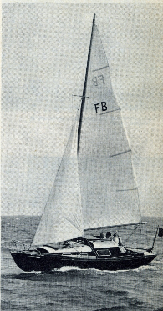
On remarquera le gréement très particulier du Folkboat, qui comprend un guignol très important et, sur chaque bord, un bas-hauban prenant à mi-hauteur du capelage de foc et un galhauban sans barre de flèche.
