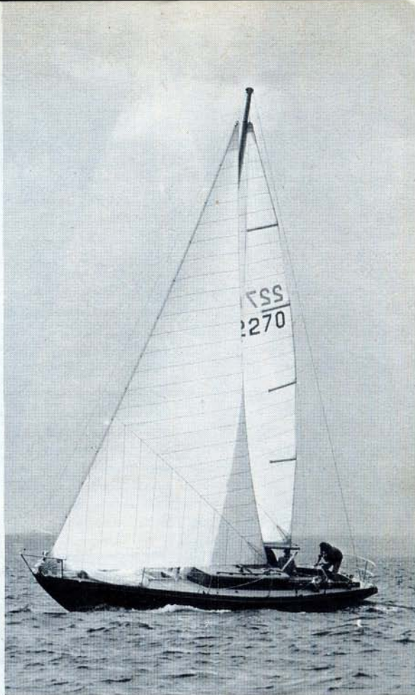
Par les changements de voiles d'avant, ou par la réduction de la grand-voile, Carter maintient constamment son bateau à l'angle de gîte optimum, lequel dépasse rarement 15°. Ici, sous génois n° 2, on notera le manque de raideur de l'étai que nous signalons par ailleurs.
